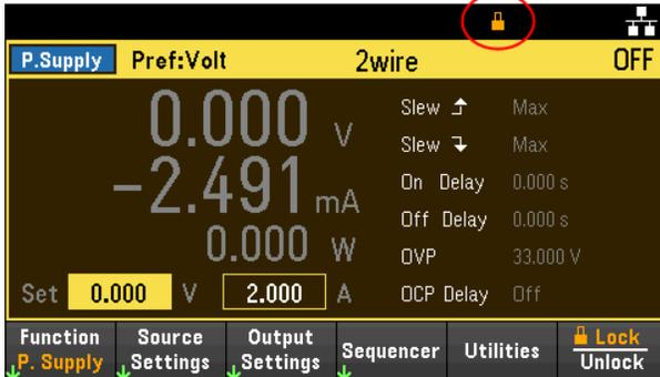
2. Appuyez à nouveau sur **[Lock|Unlock]** pour déverrouiller le panneau avant.
